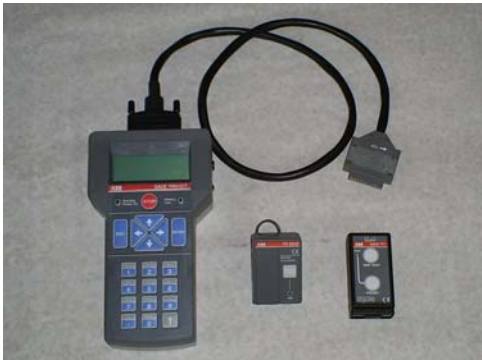
Maleta de pruebas para las unidades de protección Sace PR111/P y Sace PR112/P de interruptores ABB.
