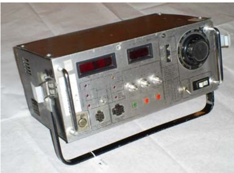
Maleta de pruebas para las unidades de protección SD-3 y SD-6 de interruptores H-2 y H-3 de Federal Pacific.
