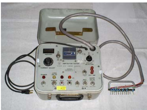
Maleta de pruebas para las unidades de protección Digitrip RMS de interruptores Cutler Hammer; Y tambien Square D Westinghouse tipo DS.
