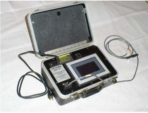
Maleta de pruebas para unidades de protección Micrologic de interruptores Masterpact NT y NW de la marca Merlin Gerin de Schneider Electric.
