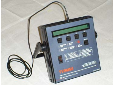
Maleta de pruebas para las unidades de protección Microversatrip de interruptores Power Break I y Power Break II de General Electric.
