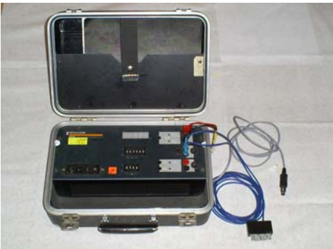
Maleta de pruebas para unidades de protección ST y STR de interruptores Masterpact marco M de la marca Merlin Gerin de Schneider Electric.
