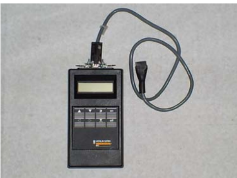
Programador para las unidades de protección ST y STR de interruptores Masterpact marco M de la marca Merlin Gerin de Schneider Electric.
